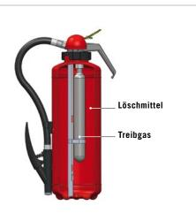
Der Treibmittelbehälter ist entweder außen oder im Innern des Löschmittelbehälters angebracht. Die umweltfreundlichen Schaum-Kartuschenlöscher (Wasser, Schaumkonzentrat und Treibmittel befinden sich in drei getrennten Behältern) sind nur als Aufladelöscher realisierbar.
